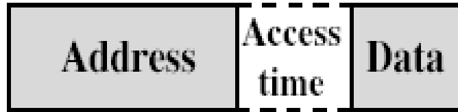
Obr. 9 Sdílená sběrnice, čtení
